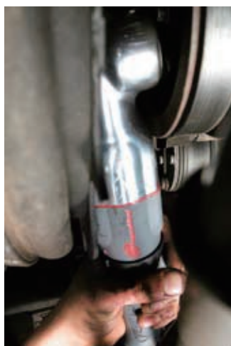
クランクシャフトバルancerボルト (ラジエーター装着状態)フォードE350 バン6.0ディーゼル
